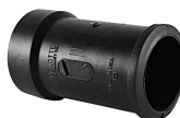
Parte No. ABS 123 Adaptador Campana Fierro Fundido (Extremos Lisos: La unión se puede hacer únicamente con empaque de compresión.) (Camp x Cem) (Adapta Espiga DWV a Campana de Hierro Fundido)
